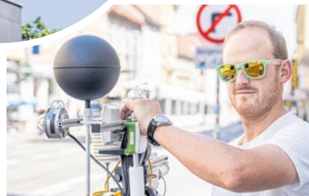
Am Boden geblieben. Roland Kerschenbauer (AEE Intec) liefert mit seinen Messungen am Boden die Referenzdaten für die Thermografieaufnahmen (siehe oben).
