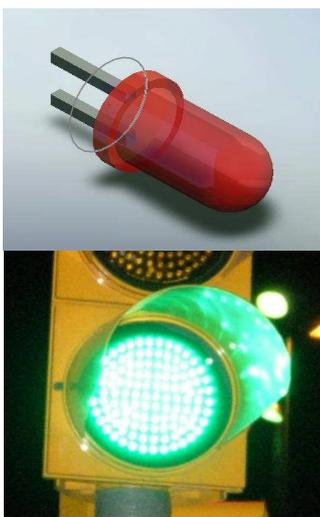
1. Deutlich geringerer Energieverbrauch: Leistung zwischen 7 Watt (LED 40 Volt) und 17 Watt (LED 230 Volt)
