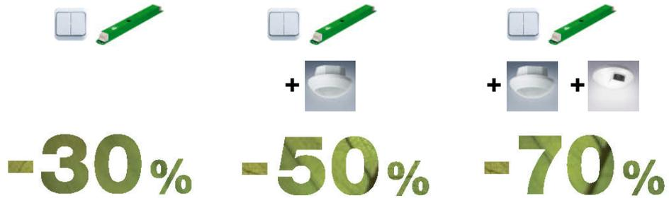
**Dimmen** Manuelles Dimmen senkt den Energieverbrauch um 30 Prozent gegenüber einer nicht dimmbaren Lichtlösung. Die Helligkeit der Leuchten wird über einen Taster an die Tätigkeit angepasst.
